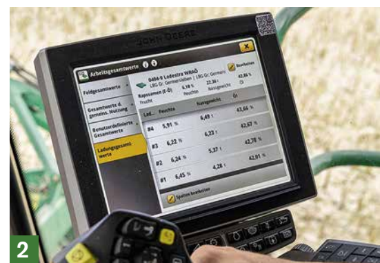
△ 1) Eine kleine Schnecke führt das Erntegut am NIRS-Sensor vorbei. 2) Der Fahrer bekommt die aktuellen Werte und die für jede Bunkerladung angezeigt.
